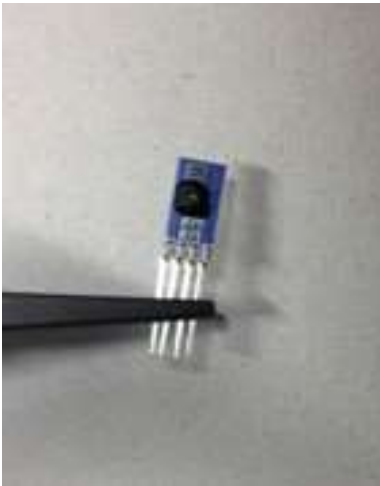
センサをリード部のみをピンセットで保持
