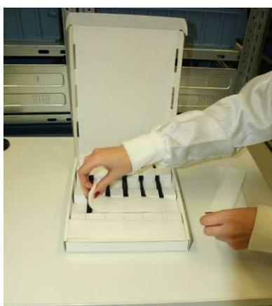
センサを覆っているプラスチック製のストライプを取り除きます。
